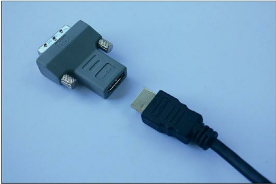
Figure 3.9 : Installation de l'adaptateur DVI au bout d'un câble HDMI.
