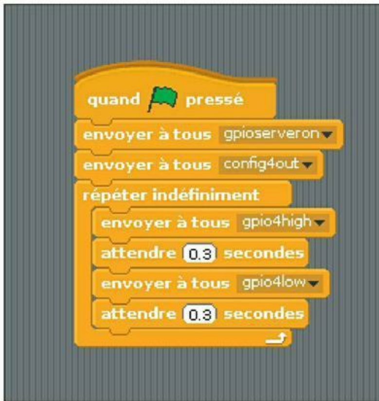
Figure 16.7 : Programme Scratch pour faire clignoter la diode LED.
