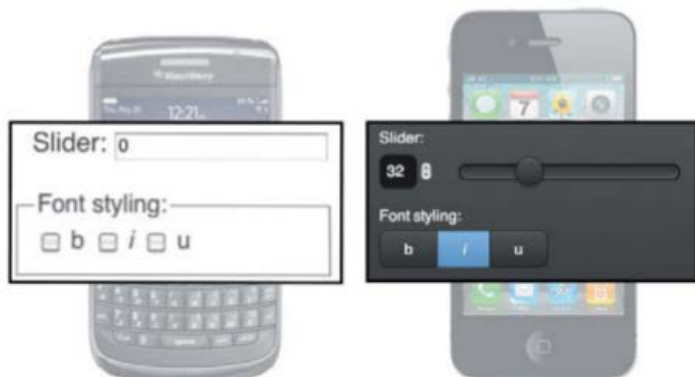
FIG 1.14 : Vue des contrôles natifs sous-jacents (à gauche) derrière une interface utilisateur améliorée (à droite)
