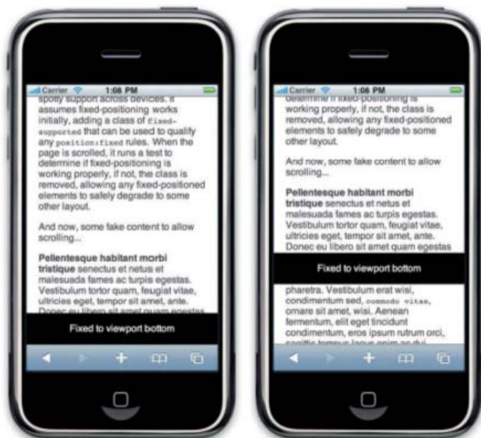
FIG 2.17 : Comportement attendu (gauche) et comportement bugué (droite) dans un navigateur supportant mal la propriété position
