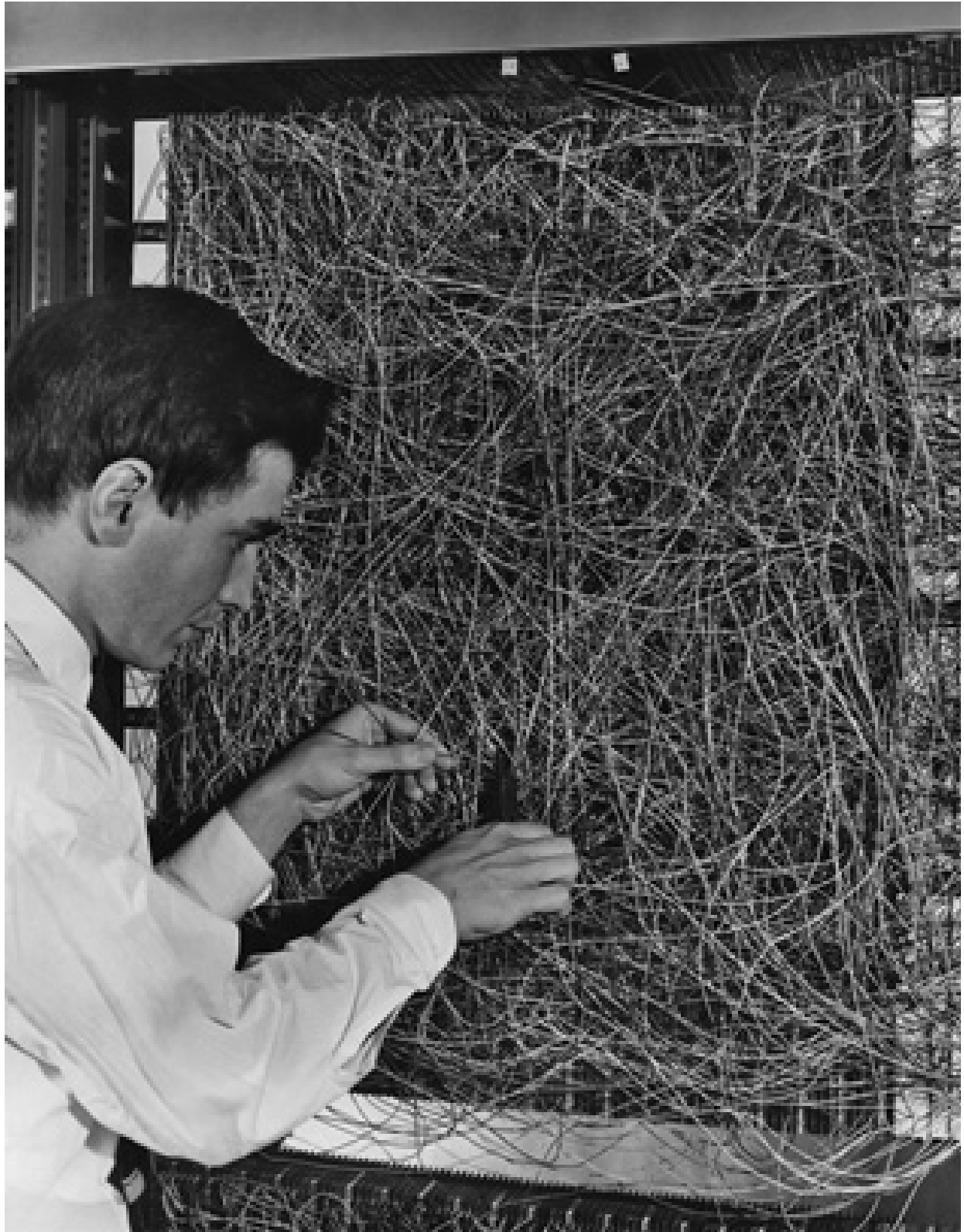
Le Mark 1 Perceptron, conçu par Frank Rosenblatt en 1957, était une machine d'apprentissage inspirée du réseau neuronal humain. Elle regroupait 400 cellules
